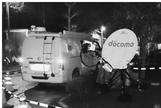
【左】台風15号の際に倒壊した衛星可搬型基地局による通信確保。【中】台風15号で被災した電柱・ケーブル。【右】台風19号の際に橋の下で被災した道路。
